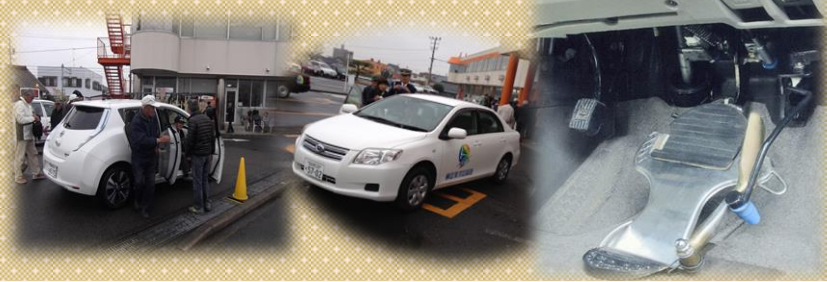
「ワンペダル」とは、アクセルとブレーキが一体化された空走距離が短くなる装置です。
